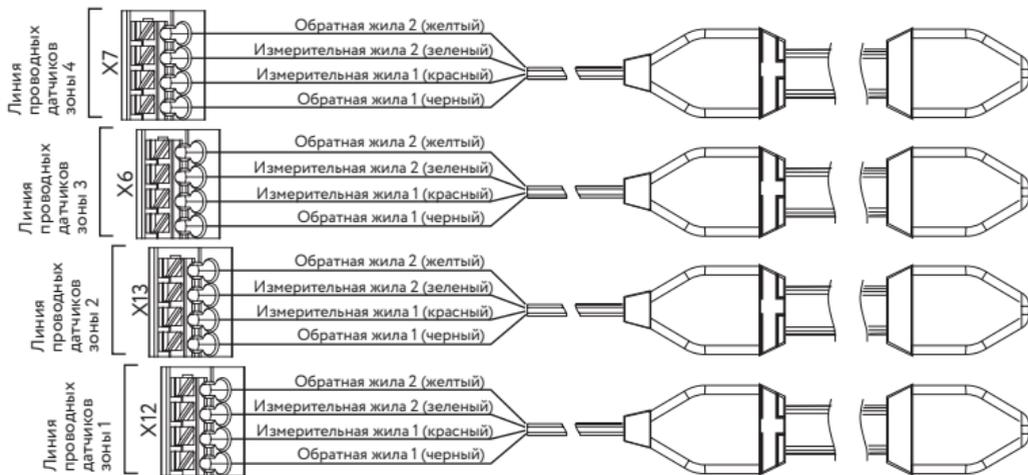
Рис.6 Схема подключения датчиков протечки воды ленточных Stahlmann TWLS к модулю управления Stahlmann HUB
