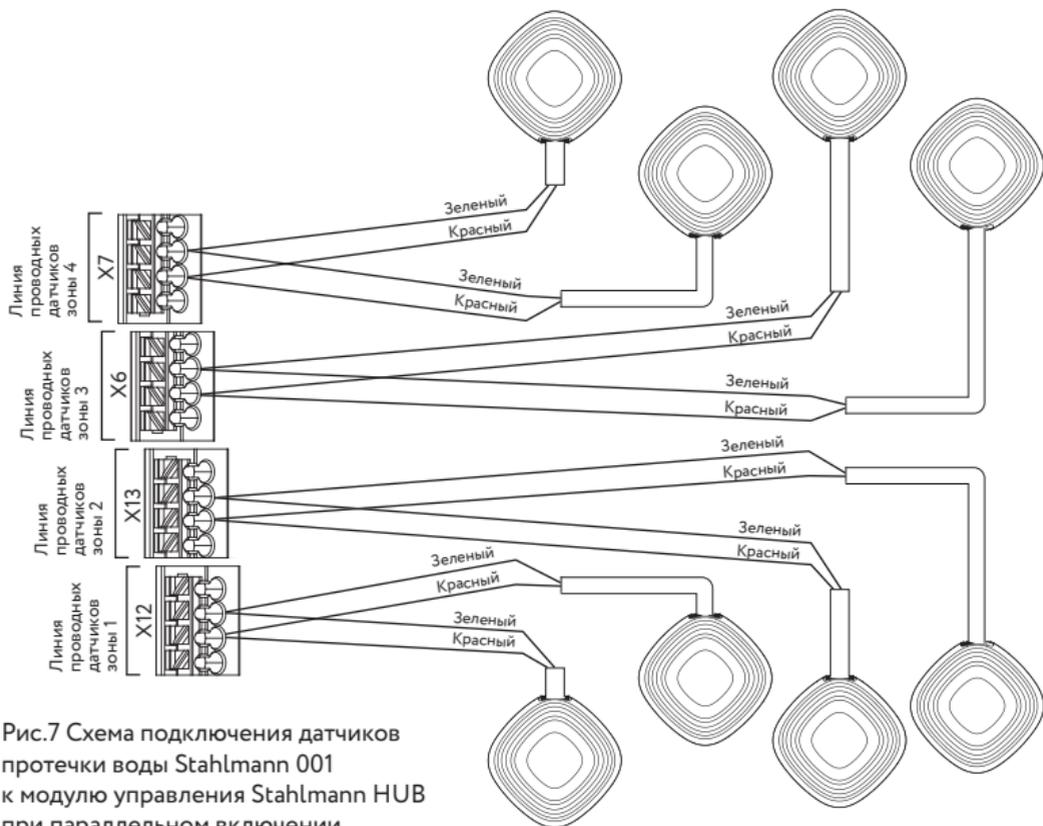
Рис.7 Схема подключения датчиков протечки воды Stahlmann 001 к модулю управления Stahlmann HUB при параллельном включении (без контроля обрыва)
