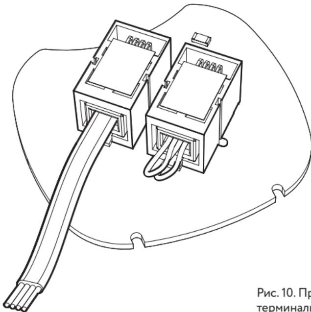
Рис. 10. Пример установки терминального разъема
