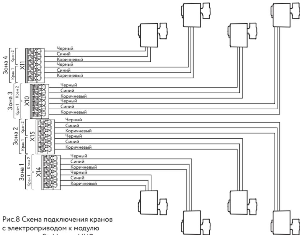
Рис.8 Схема подключения кранов с электроприводом к модулю управления Stahlmann HUB
