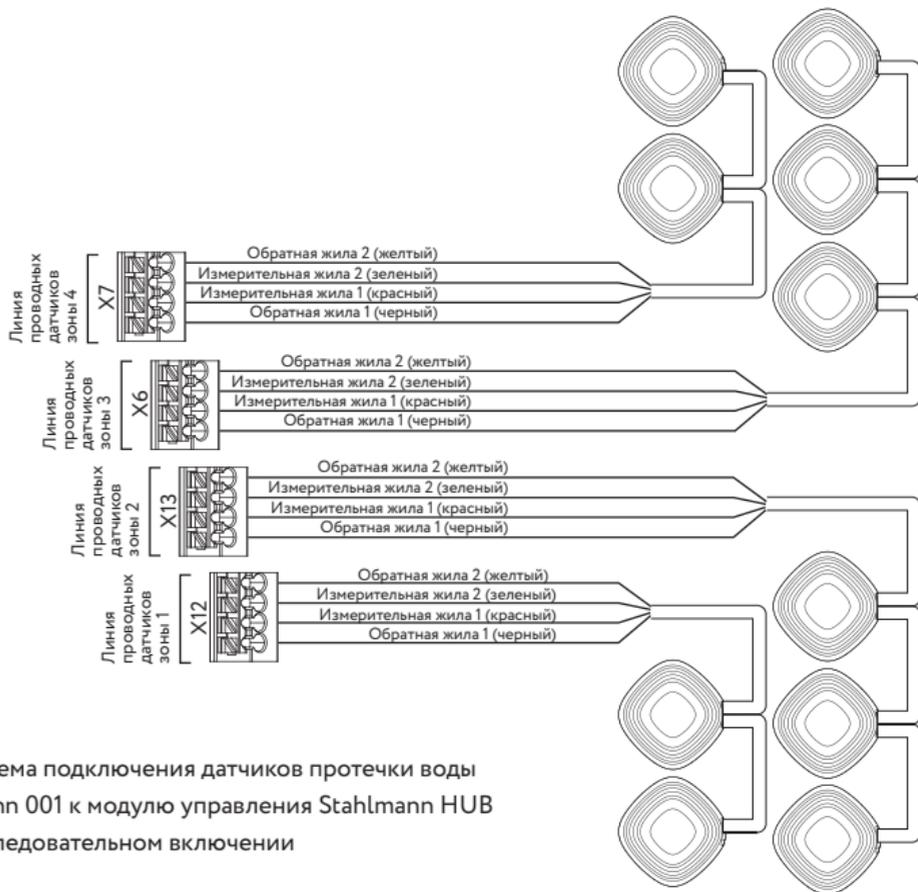
Рис.5 Схема подключения датчиков протечки воды
