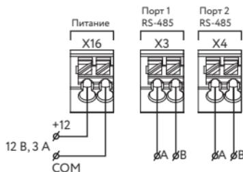
Рис.4 Схема подключения электропитания к модулю управления Stahlmann HUB
